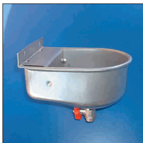
Art.100/S ABBEVERATOIO INOX A LIVELLO COSTANTE CON VALVOLA DI SCARICO Abbeveratoio di acciaio inox con capacità di 1,5 litri applicabile a qualsiasi tipo di rete, tubo o al muro. Un galleggiante mantiene il liquido ad un livello costante e si alimenta direttamente dalla rete idrica o per caduta tramite un serbatoio. La valvola di scarico permette un agevole svuotamento dopo la pulizia.
